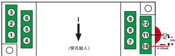
**P.S: 电流穿孔输入；10与11位端子为电源端子和输出端子；1-9、12位端子为空脚，无须接线。**
